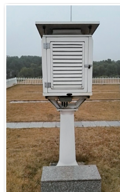
百叶箱 (内置空气温度和湿度传感器)
