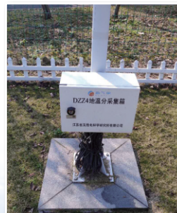
地温观测仪器 (观测地表、浅层及深层温度)
