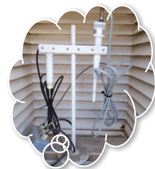
百叶箱 (内置空气温度和湿度传感器)
